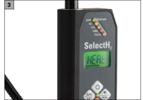
Die Aufheizphase wird durch das Wort „HEAT“ signalisiert und dauert ca. 50 Sekunden.
