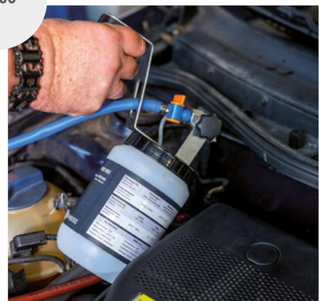
5. Schalten Sie die Lüftung auf Stufe 1 ein und sprühen Sie das Desinfektionsmittel durch die Luftansaugöffnung der HVAC-Anlage in den Innenraum ein. Leiten Sie das Mittel ein, bis der Innenraum des Fahrzeugs sichtbar eingenebelt ist. Lassen Sie den Nebel ca. eine Minute lang einwirken.
