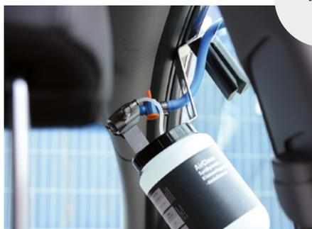
Stellen Sie eine externe Spannungsversorgung des Bordnetzes her oder lassen Sie den Motor laufen. Schließen Sie die Türen oder lehnen Sie die Tür an, durch die der Lüftungsversorgungsschlauch führt, um ein übermäßiges Entweichen des Nebels zu vermeiden. Öffnen Sie die Druckluftversorgung und lassen Sie das Desinfektionsmittel einströmen, bis eine deutliche Sättigung/Nebelbildung im Innenraum zu sehen ist.
