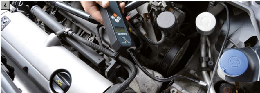
Führen Sie das Gasspürgerät mit gleichmäßiger Geschwindigkeit oberhalb von Schlauchverbindungen und Komponenten vorbei. Auf dem Display können Sie die Wasserstoffkonzentration ablesen. Steigende ppm-Werte deuten auf ein Leck hin.
