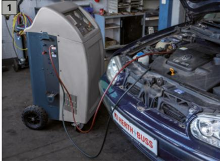
Evakuieren Sie die Klimaanlage mit einer geeigneten Klimaservicestation.
