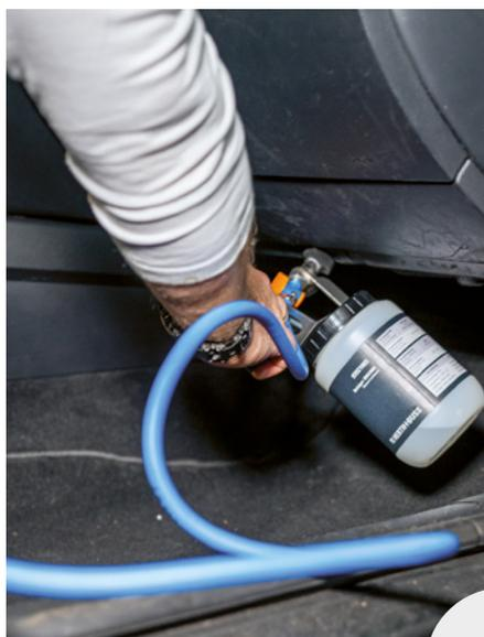
7. Schalten Sie nun das Gerät aus und entfernen Sie die Sprühpistole. Schließen Sie die Tür und lassen Sie die Lüftung für weitere 2-5 Minuten laufen.
