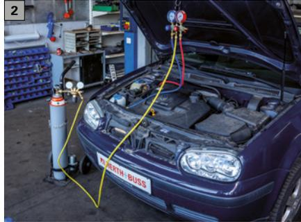
Befüllen Sie nun die Hochdruckseite der Klimaanlage. Mit Hilfe des Erweiterungssatzes, Lecksuche-Set kann gleichzeitig auf Hoch- und Niederdruck befüllt werden.
