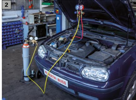
Désormais, remplissez le côté haute pression du système de climatisation. À l'aide du kit d'extension, le kit de détection de fuites peut être rempli côté basse pression et côté haute pression en même temps.
