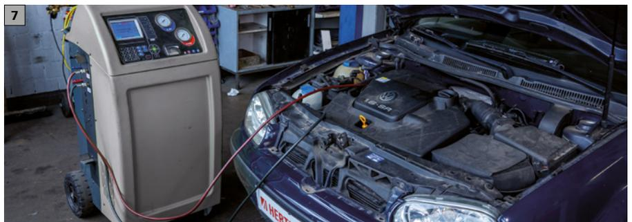
Remplissez ensuite le système de climatisation avec le fluide frigorigène adapté. Effectuez enfin un contrôle de fonctionnement.
