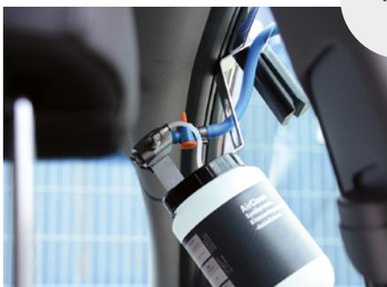
Fermez les portes et rabattez la porte sur le tuyau d'alimentation de la ventilation afin d'éviter une fuite excessive de brouillard. Ouvrez l'alimentation en air comprimé et laissez le désinfectant se répandre jusqu'à ce qu'un brouillard/effet de saturation soit nettement visible dans l'habitacle.
