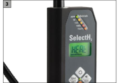
La phase d'échauffement est signalée par le mot « HEAT » et dure environ 50 secondes.
