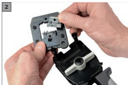
La CrimPro 40 est adaptée aux utilisations les plus diverses. L'adaptation de remplacement rapide des têtes d'outil permet d'adapter rapidement et de façon non compliquée l'outil de base à chaque besoin de traitement. L'assortiment de kits d'inserts de sertissage permet le traitement des connecteurs de différentes plages de diamètre et tailles. Avec une force de pression élevée (environ 3,5 kN), la Crimpro 40 avec ses adaptateurs et inserts de pince de sertissage est particu-
