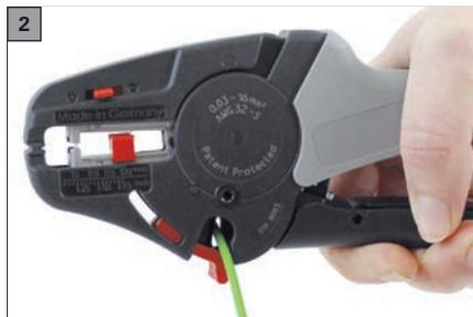
Cet outil de dénudage haute qualité permet de dénuder sans les endommager des conducteurs massifs ou à fils fins de 0,03 – 16 mm<sup>2</sup> dotés d'une isolation PVC. Le système ingénieux d'ajustage automatique à la plage de sections exclut tout risque d'endommagement et d'effilochement des conducteurs. La fonction de coupe intégrée (avec système de protection des mains) permet par ailleurs de sectionner avec
