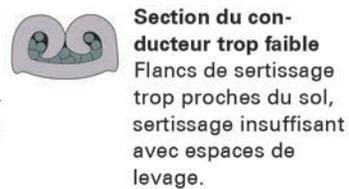
Réglage incorrect de la hauteur de sertissage
