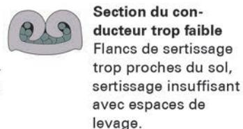
**Réglage incorrect de la hauteur de sertissage**
