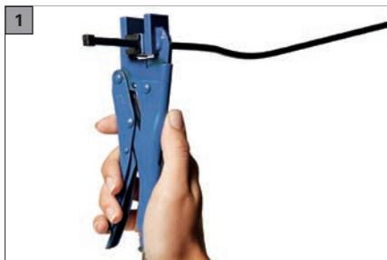
Cette pince à sertir sert spécialement à travailler les systèmes DC (double clic). Le sertissage d'un connecteur DC doit dans tous les cas être effectué avec la pince de montage DC spéciale.
