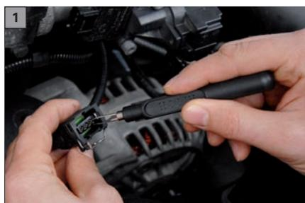
Le kit 3 pièces d'outils de déverrouillage permet d'ouvrir les connexions les plus courantes. Le kit comporte trois extracteurs de câbles avec six lames pour les sertisseurs courants. Les pointes d'outil sont en acier
