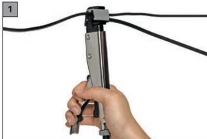
Cette pince à sertir est spécialement conçue pour travailler les systèmes de câblage P&R (Press & Ready System).
