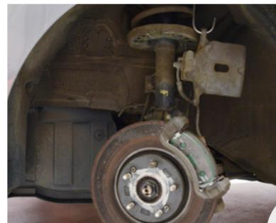
4. Retirez le disque de frein, effectuez un contrôle visuel des composants du frein, et remplacez-les le cas échéant.
