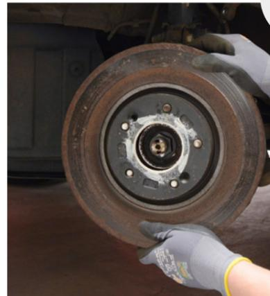
5. Brossez/Nettoyer les surfaces d'appui à l'aide d'une ponceuse pour moyeu de roue pour éliminer la rouille. Attention à ne pas endommager le moyeu de roue !
