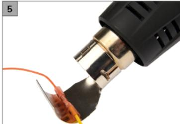
Le connecteur doit ensuite être rétracté à l'aide d'un sèche-cheveux.
