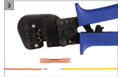
Un connecteur à écrasement, à rétraction ou à brasage peut être utilisé pour le raccordement.
