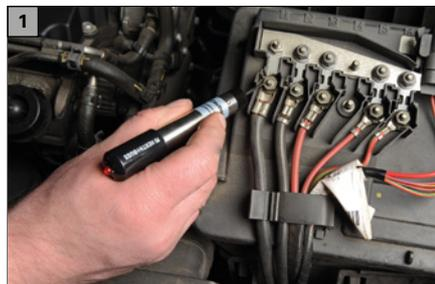
Le détecteur de tension PlusMinus 3-28 est compatible avec les composants électroniques tels que les appareils de gestion moteur, capteurs, etc. Un câble de masse ou une borne de terre ne sont pas requis.
