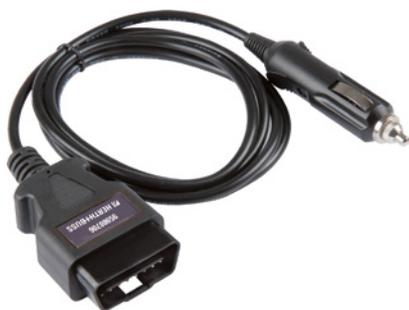
Le condensateur de maintien Keeper 5 alimente le véhicule en tension pendant le remplacement de batterie pour que les différents réglages comme les codes radio, la mémoire de position de siège, etc. soient conservés.
