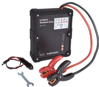
Contrairement aux dispositifs classiques d'aide au démarrage, cet appareil ne dispose pas de batterie interne. Des condensateurs très puissants sont utilisés pour l'accumulation d'énergie. Ceux-ci peuvent emmagasiner et restituer en très peu de temps la quantité d'énergie nécessaire au démarrage du moteur. L'appareil est entièrement indépendant du réseau et peut même, dans le pire des cas, être chargé avec le reste d'énergie contenu dans la
