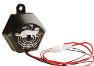
Pour être mieux protégé contre les morsures des mustélidés, il est recommandé d'installer un anti- mustélidés au-dessus de chaque trou d'entrée dans le compartiment du moteur. L'emplacement de montage devrait dans ce cas se trouver au point le plus bas possible. L'appareil travaille à une cadence de 12 secondes (voir LED). Monter l'appareil de façon à ce que l'illustration du mustélidé soit orientée
