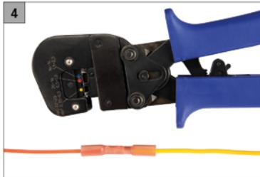
Les câbles doivent ensuite être sertis l'un après l'autre avec le connecteur. Dans cet exemple, notre pince de sertissage CrimPro10 est utilisée alternativement à la CrimPro30.
