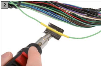
Grâce à son arrivée de gaz réglable et aux buses fournies, ce chalumeau convient pour tous types de travaux allant du chauffage professionnel de gaines thermorétractables à la soudure de cosses.
