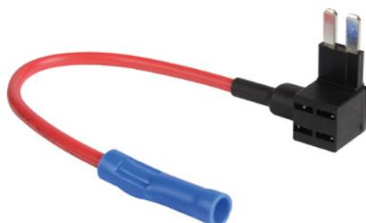
Le support de dérivation permet de raccorder rapidement et simplement des consommateurs supplémentaires. Le fusible jusqu'à présent enfiché dans la boîte à fusibles est extrait et remplacé par le support supplémentaire. Ensuite, le fusible est enfiché dans le logement
