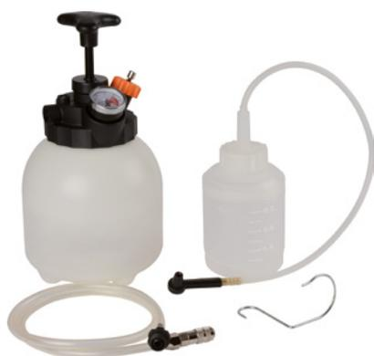
Cet outil sert à purger les circuits hydrauliques de freinage et d'embrayage. À cet effet, l'outil est raccordé au système hydraulique par l'intermédiaire du vase d'expansion. À l'aide de la pompe manuelle intégrée, le réservoir de stockage est mis sous pression. Lors de la purge (à l'ouverture des raccords de purge), le liquide de frein est comprimé dans les conduites hydrauliques pour être remplacé en quan-
