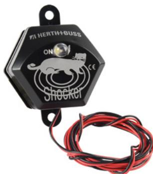
Plus de puissance – Plus de protection – Plus de sécurité Pour la première fois, un système de réflexion acoustique est utilisé pour un anti-mustélidés. Ceci permet d'atteindre un rayonnement à 360°. Au-dessus du haut-parleur Piezo avec membrane NAWI est agencé un cône de forme convexe qui à la même forme
