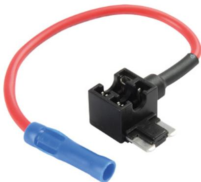
Le support de dérivation permet de raccorder rapidement et simplement des consommateurs supplémentaires. Le fusible jusqu'à présent enfiché dans la boîte à fusibles est extrait et remplacé par le support supplémentaire. Ensuite, le fusible est enfiché dans le logement
