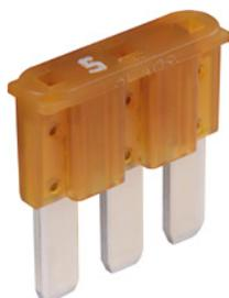
Le fusible MICRO3 dispose de trois contacts puisque deux fusibles se partagent un contact central. Grâce au petit gabarit, il est possible de sécuriser plus de circuits électriques dans un petit espace. Petites dimensions en combi-
