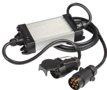
Charge de compensation de résistance pour adapter les feux à diodes lumineuses de la remorque aux véhicules avec surveillance des ampoules. La défaillance d'une unité LED est détectée et la charge de compensation est coupée.
