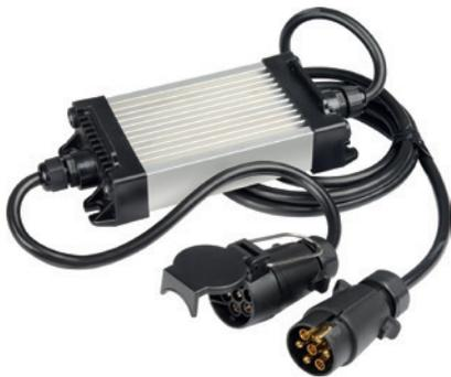
Charge de compensation de résistance pour adapter les feux à diodes lumineuses de la remorque aux véhicules avec surveillance des ampoules. La défaillance d'une unité LED est détectée et la charge de compensation est coupée.
