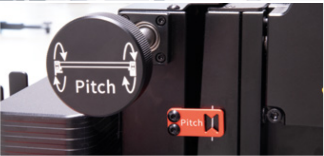
Bouton rotatif pour le réglage de l'angle d'inclinaison verticale
