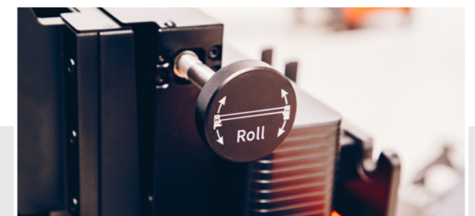
Drehknopf zur Einstellung des horizontalen Neigungswinkels
