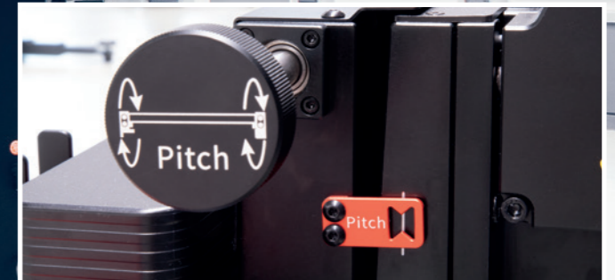
Drehknopf zur Einstellung des vertikalen Neigungswinkels
