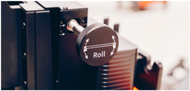
Drehknopf zur Einstellung des horizontalen Neigungswinkels
