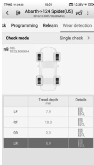
**Abbildung 4-37 Beispiel für Einfache Prüfung-Bildschirm**
