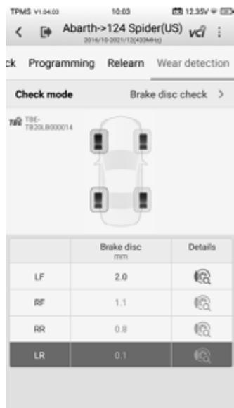
**Abbildung 4-38 Beispiel für Prüfung der Bremsscheiben-Bildschirm**
