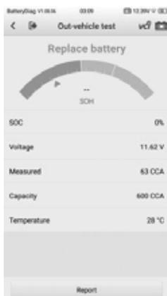
**Abbildung 6-12 Beispiel für Außer-Fahrzeug-Testergebnisse-Bildschirm**
