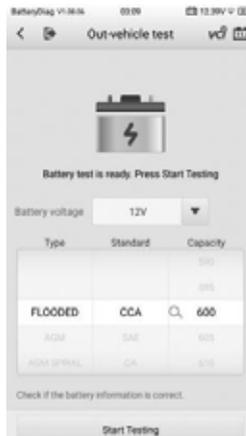
**Abbildung 6-11 Beispiel für Außer-Fahrzeug-Test-Bildschirm**
