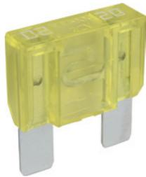
Die 32-V-Standardsicherung in Maxi-Bauform. Merkmale sind ein dreiteiliger Aufbau mit Kupferkontakten, niedriger Spannungsabfall und hohe Zuverlässigkeit unter rauen Umgebungsbedingungen. Die transparente Abde-
