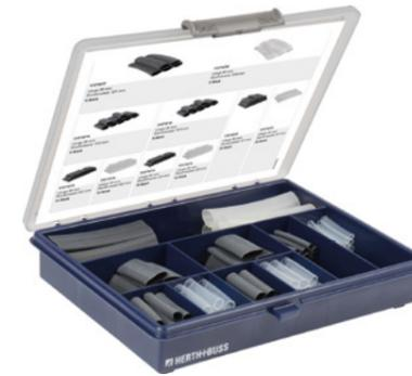
Das Sortiment, Wärmeschrumpfschlauch enthält die am häufigsten benötigten Größen und Längen. Die dünnwandigen Schläuche enthalten einen heißschmelzenden Innenkleber, der beim Erhitzen austritt und die Reparaturstelle vor Feuchtigkeit und Korrosion schützt. Durch
