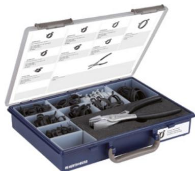
Dieses Sortiment beinhaltet die gängigsten Federbandschellen (DIN 3021) für einen Leitungsdurchmesser von 14 bis 47 mm. Des Weiteren ist ein leeres Fach zur freien Bestückung enthalten. Federbandschellen haben den Vorteil gegenüber herkömmlichen Schlauchschellen, dass sie sich im Applikationsbereich je nach Temperatur dem Durchmesser anpassen. So sind alle im Kfz befindlichen Luft- oder Kraft-
