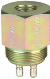
Schalterfunktion: elektr. Schaltleistung: Schließer 30 W Montageart: geschraubt Betriebsart: pneumatisch
