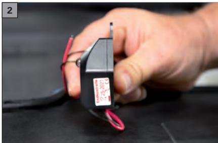
Um einen besseren Schutz gegen Marderverbiss erzielen zu können, sollte über jedes Einschluflloch im Motorraum ein Marder-Schocker installiert werden. Hierbei sollte der Einbaort so tief wie möglich gewählt werden. Das Gerät arbeitet im 12-Sekundentakt (siehe LED). Das Gerät ist so einzubauen, dass es mit der Marderabbildung in die Einschluflöffnung zeigt. Sollten mehrere Öffnungen vorhanden
