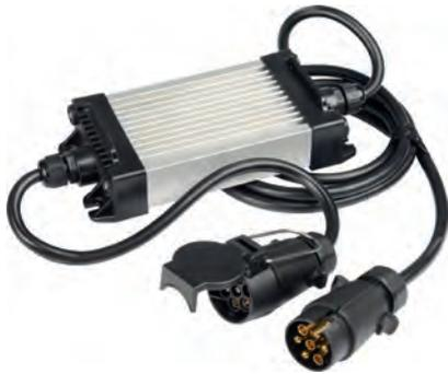
Widerstands-Ersatzlast zur Anpassung von Leuchtdioden- Anhängerleuchten an Fahrzeugen mit Glühlampenüberwachung. Der Ausfall einer LED-Einheit wird erkannt und die Ersatzlast abgeschaltet.
