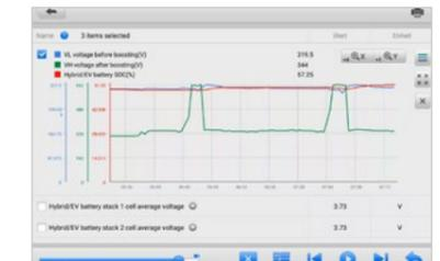
Hier sehen Sie die Oszilloskop Ansicht bei einer Anwendung. Die verschiedenen Spannungsbereiche werden miteinander verglichen.
