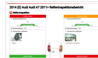
Durch die Verwendung unseres Prüfgerätes für die Reifenprofiliefe TBE200EU können Sie die Profiltiefe schnell und einfach messen. Die Ergebnisse dieser Messung werden in einem übersichtlichen Reifeninspektionsbericht dargestellt.
