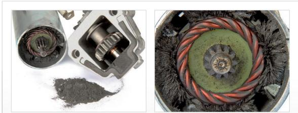
**Kupplungs- und Metallstaubbelastung**
