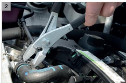
Dieses Sortiment beinhaltet die gängigsten Federbandschellen (DIN 3021) für einen Leitungsdurchmesser von 14 bis 47 mm. Des Weiteren ist ein leeres Fach zur freien Bestückung enthalten. Federbandschellen haben den Vorteil gegenüber herkömmlichen Schlauchschellen, dass sie sich im Applikationsbereich je nach Temperatur dem Durchmesser anpassen. So sind alle im Kfz befindlichen Luft- oder Kraft-
