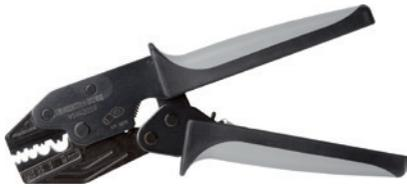
Die Quetschzange eignet sich für die Verarbeitung von nicht isolierten Kabelschuhen (DIN 46234, DIN 46230, DIN 46341) mit geschlossener Crimphülse. Die entriegelbare
