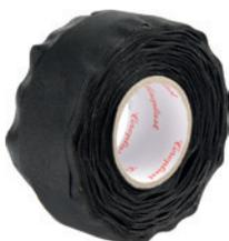
Das Band wird zur Bündelung und Bandagierung von Kabelsätzen eingesetzt. Seine spezielle Konstruktion ermöglicht die Fertigung hochflexibler Kabelsätze. Außerdem kann der Kontakt von Klebstoff und Leitungen weitgehend vermieden werden. Durch die überlappende Wickeltechnik (siehe Anwendungsbeispiel), wird eine Doppelwicklung überflüssig. Des Weiteren gehen mit der Ein-
