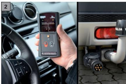
Mit dem Blinker kann sowohl die Belegung der Anhängersteckdose als auch die Beleuchtungsfunktion des Anhängers von nur einer einzelnen Person geprüft werden. Das Prüfgerät ersetzt und simuliert wahlweise das Zugfahrzeug oder den Anhänger. Der Anwender kann sich dabei die Beleuchtungssignale des Fahrzeugs auf der Fernbedienung anzeigen lassen oder mit der Fernbedienung alle Leuchten des Anhängers ansteuern.
