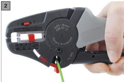
Mit diesem hochwertigen Abisolierwerkzeug können sowohl massive als auch feindrähtige Leiter mit PVC Isolation von 0,03 – 16mm<sup>2</sup> beschädigungsfrei abisoliert werden. Eine Beschädigung und ein Aufspießen der Leiter wird durch die intelligente Selbsteinstellung auf die Querschnittsbereiche verhindert. Die integrierte Schneidefunktion (mit Handschutz) ermöglicht zusätzlich das präzise Schneiden von massiven (bis 6 mm<sup>2</sup>) und
