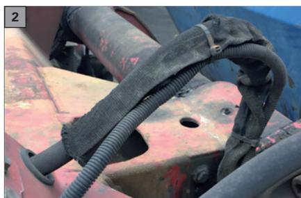
Dieser geflochtene Stoff-Faserschlauch wurde in erster Linie entwickelt, um einen hohen mechanischen Abriebsschutz für Komponenten wie Gummischläuche, Kunststoffrohre und Kabelbündel sicher zu stellen. Darüber hinaus
